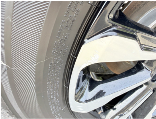
Schaden Felge hinten links
