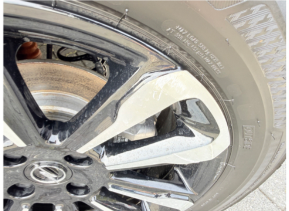
Schaden Felge hinten links
