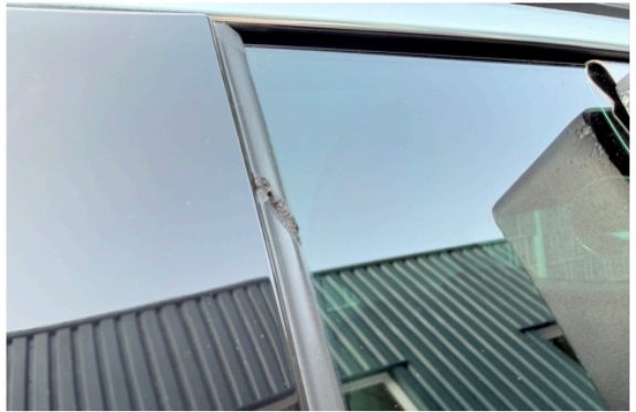
Beschädigung Türdichtung hinten links
