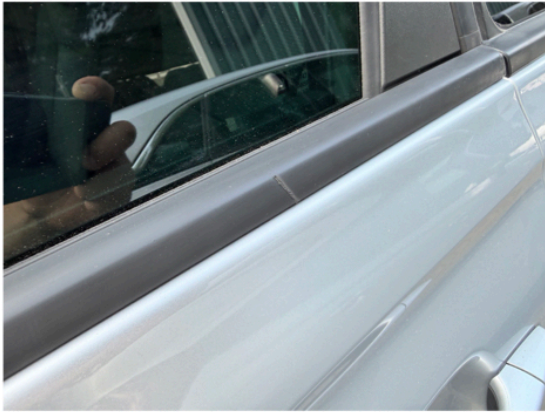
Beschädigung Türdichtung vorne links
