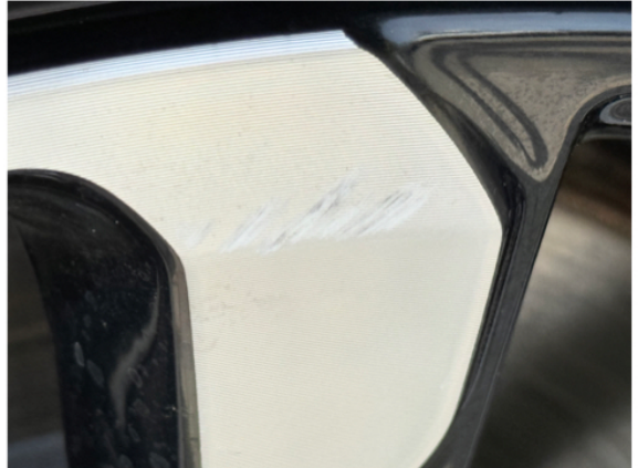
Schaden Felge vorne links
