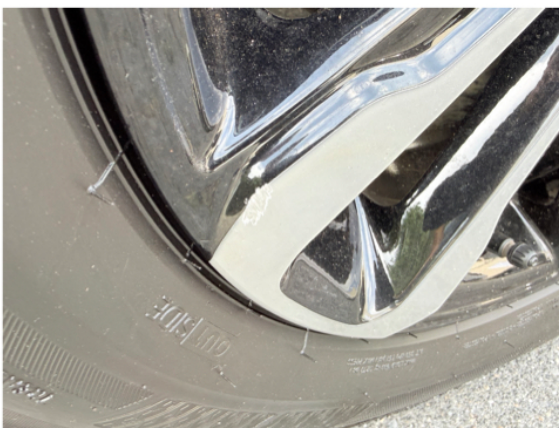
Schaden Felge hinten rechts
