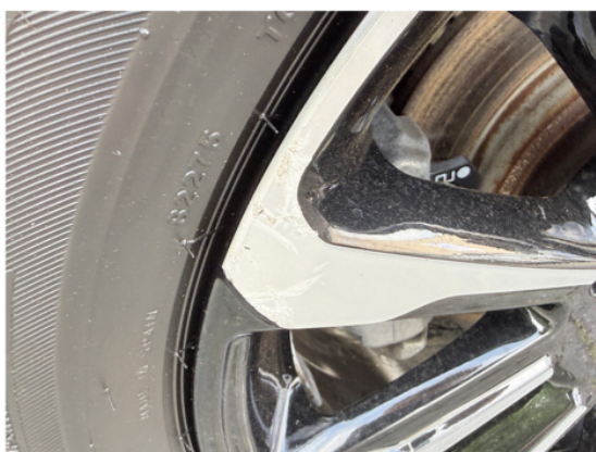
Schaden Felge hinten rechts
