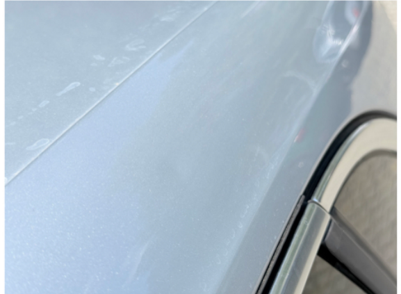
Dachholm links leichter Hagelschaden
