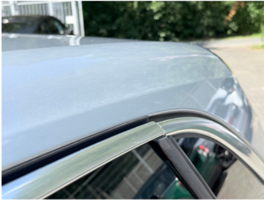
Dachholm links leichter Hagelschaden
