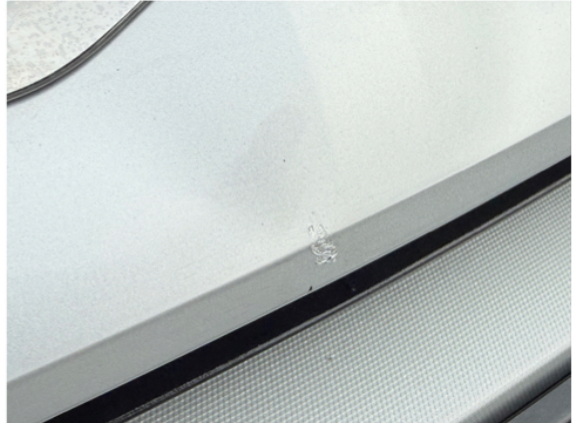
Steinschlag Stoßstange vorne mittig
