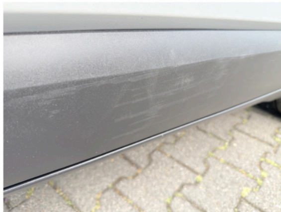
Schaden Türleiste vorne rechts
