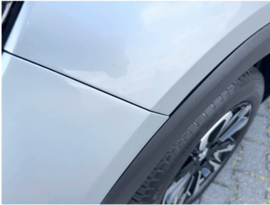
Stoßstange vorne links Spaltmaß ungenau
