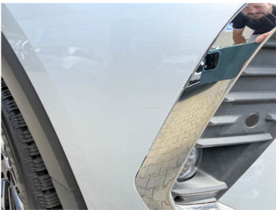
Schaden Stoßstange vorne links
