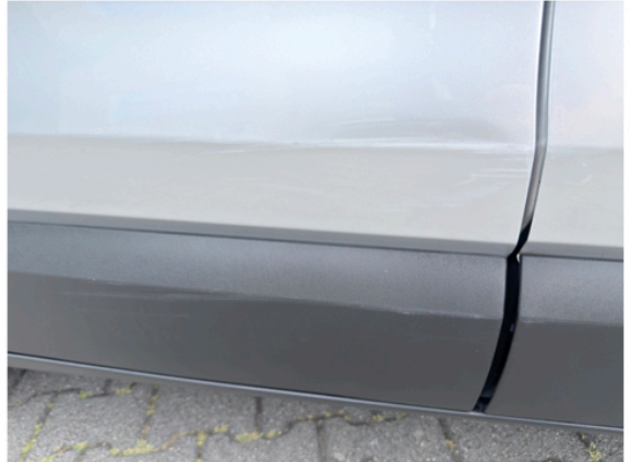
Schaden Tür hinten rechts, Delle und Kratzer
