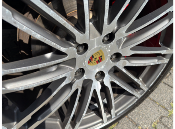
Felge hinten rechts Oxidation
